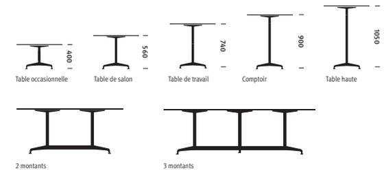
\* Les surfaces rondes et carrées d'une largeur supérieure à 1 400 mm sont montées sur un piètement à quatre colonnes. Les surfaces d'une largeur supérieure à 1 500 mm sont divisées en deux éléments, selon les matériaux utilisés.
